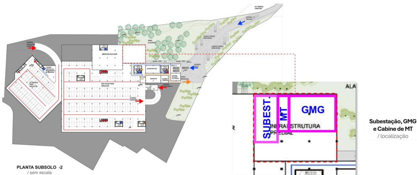
Figura 129 – Compatibilização – Planta do 2º Subsolo e localização da Subestação, GMG e Cabine de MT
