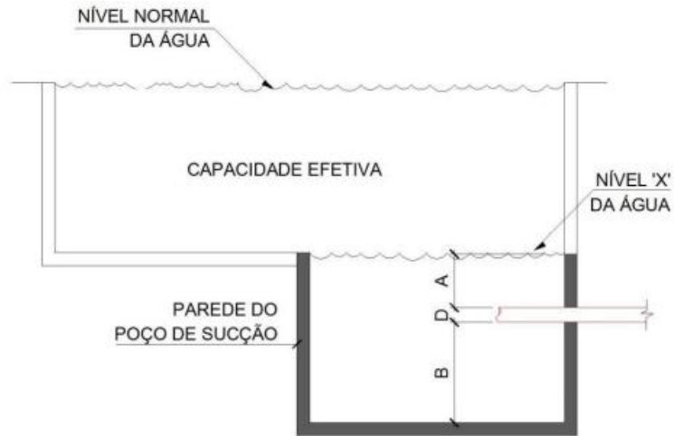
Figura B.2 - Tomada lateral de sucção para bomba principal
